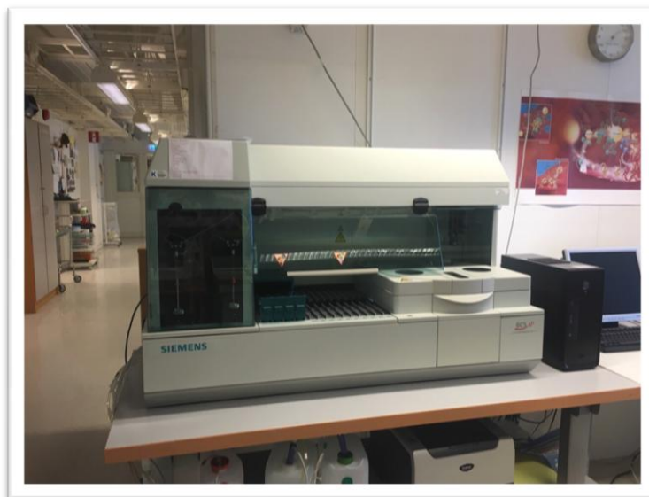
Слика 1. BCS® XP System апарата за колорифотометријско одређивање ендогеног тромбин потенцијала
